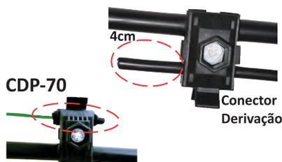
3. Aperte o parafuso inicialmente com a mão até que o conector fixe suficientemente os condutores para posteriormente concluir a instalação com a chave, observe que na região da conexão os condutores devem estar em paralelo.
