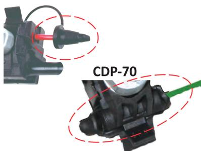
5. Durante a aplicação do torque com a chave sextavada (estrelada) ou cachimbo, assegure-se que os condutores estão alinhados com as canaletas do conector, observando também o posicionamento correto da chave pois caso contrário a cabeça fusível do parafuso poderá romper antes da aplicação do torque necessário.
